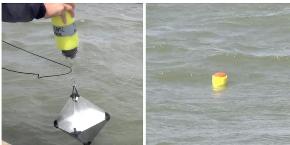
Fig. 6 a) Drifter con ancora galleggiante. b) Drifter in galleggiamento
